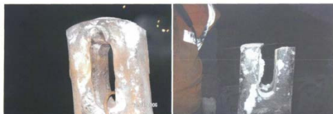
Выработка, трещина, излом хвостовика автосцепки
