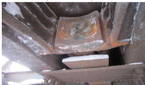
Излом большого зуба автосцепки из-за неправильного ведения поезда
