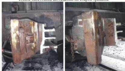
Излом большого зуба автосцепки из-за неправильного ведения поезда
