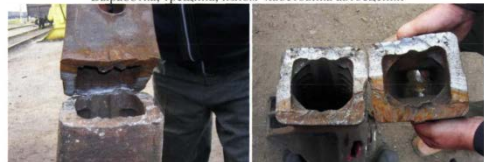
Излом хвостовика автосцепки по старой трещине
