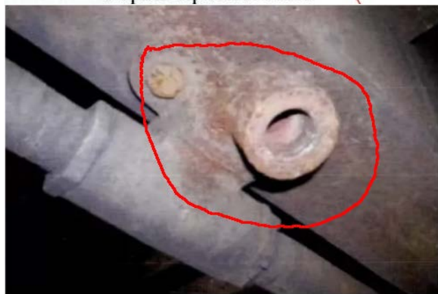
Обрыв подводящей трубки
