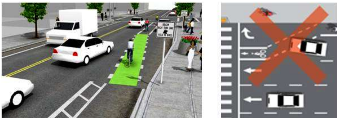
Рисунок 3.15. Пример планировочного решения с организацией пересечения поворачивающими направо автомобилями велополосы в стесненных условиях и пример недопустимого решения
