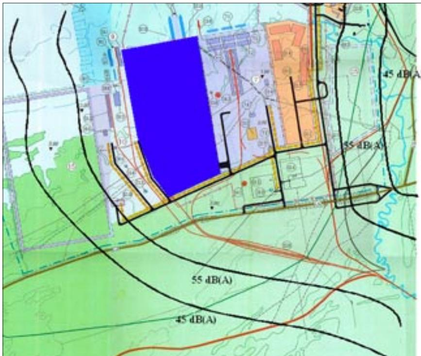
Рис. 28 Контурные эквивалентных уровней шума при работе многоцелевого терминала.
