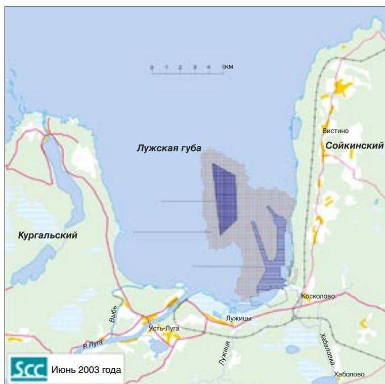
Рис. 24 Расположение участка подводной свалки и акваторий дноуглубления в портовом комплексе. На карте также показаны зоны максимального портового воздействия роста мутности из-за работ по дноуглублению для всего портового комплекса.
