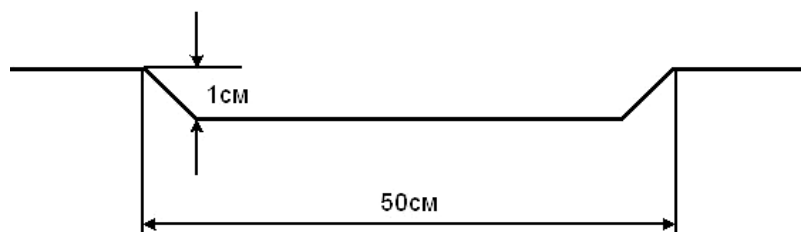
Рисунок 4.1 - Шумовые полосы, вырезанные на проезжей части
