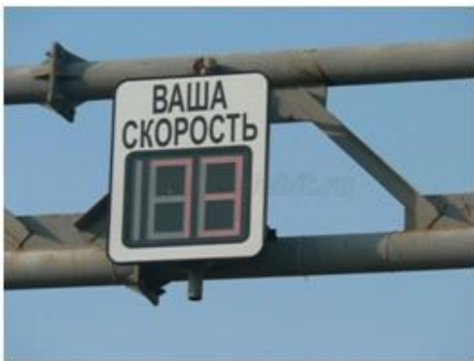
Рисунок 9.1 - Установка дорожных знаков с обратной связью
