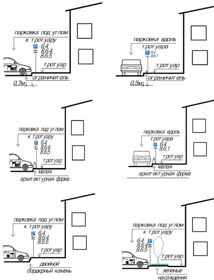
Рисунок 8.4 – Ограничение доступа автомобилей к тротуару при использовании ограничителей, малых архитектурных форм, зеленых насаждений при различных
