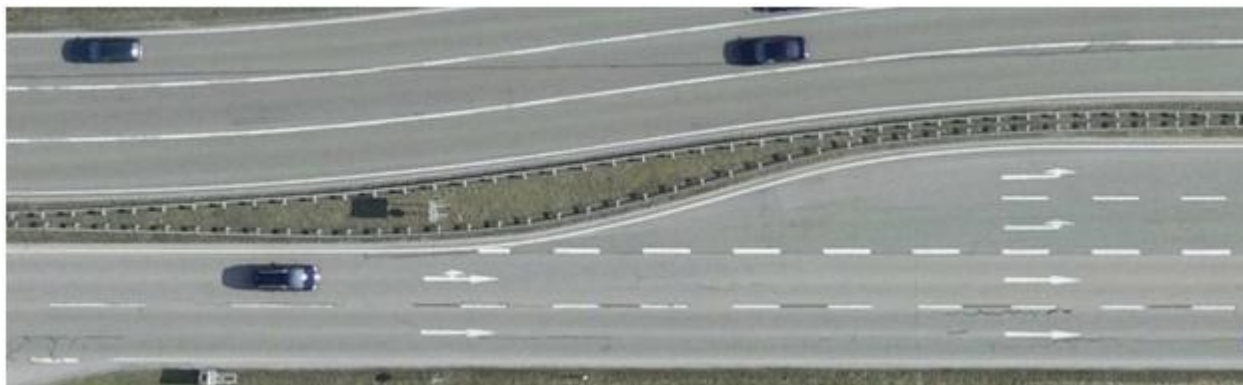
Рисунок 3.12 – Отгонка выделенных для поворотов полос: L - длина отгонки; R – радиус кривых в плане
