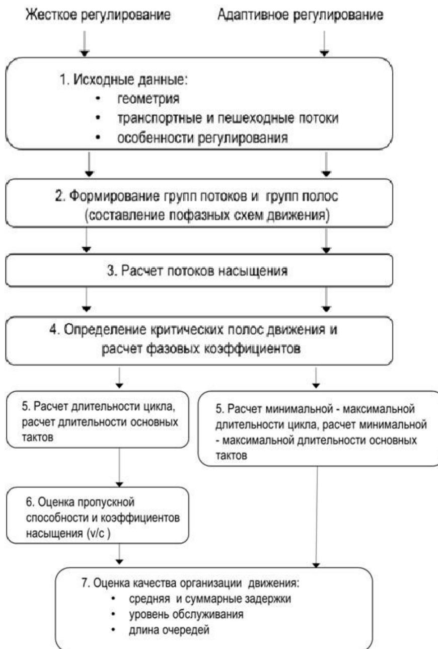
Рисунок 1.5 - Общая последовательность проектирования регулируемого перекрестка.
