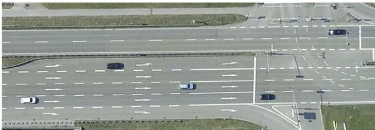
Рисунок 3.13 – Пример устройства выделенной полосы для левого поворота – использование разделительной полосы, ширина которой превышает ширину полосы движения на 0,5 – 1,0 м.
