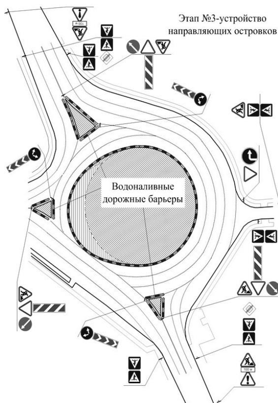
Рисунок 2.24 - Схема организации движения при реконструкции кольцевого пересечения (этап № 3 – устройство направляющих островков)
