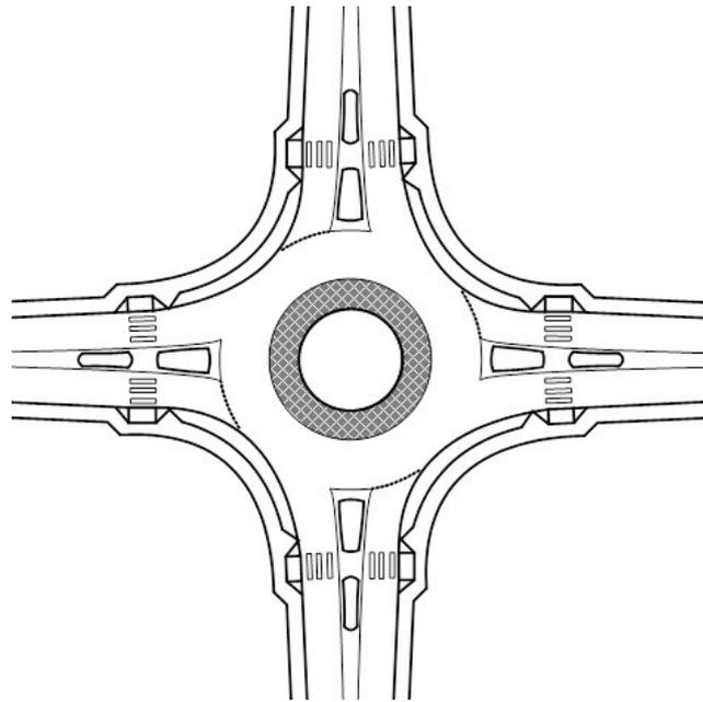
Рисунок 1.20 - План и параметры узла с объезжаемым островком
