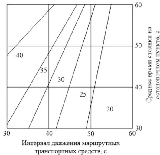
Рисунок 2.8 - Номограмма выбора расстояния удаления остановочного пункта (с двумя местами для маршрутных транспортных средств)
