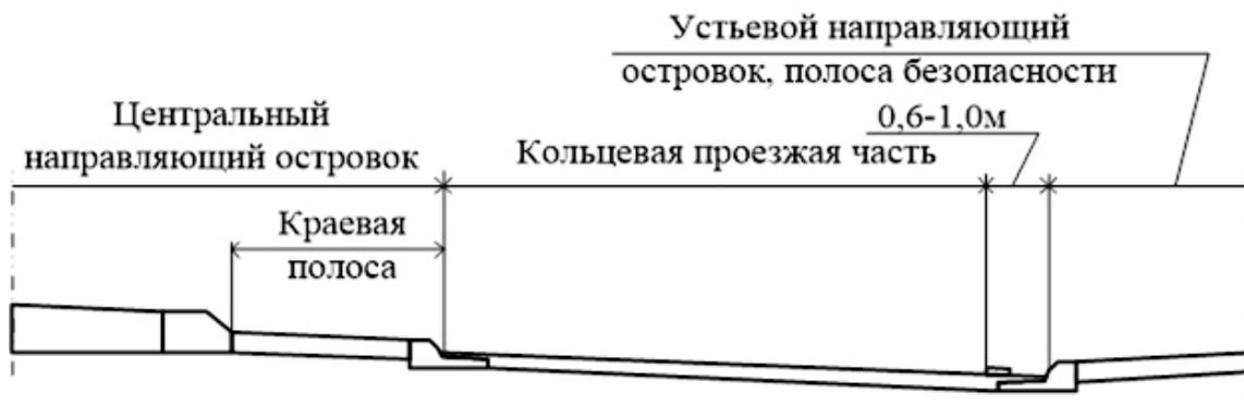
Рисунок 1.19 - Параметры и схема устройства краевых полос
