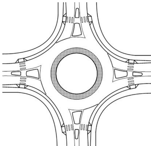
Рисунок 1.17 – Планировка малого кольцевого пересечения (пример)
