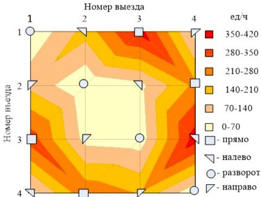
Рисунок 3.7 - Изображение распределения интенсивности движения на кольцевом пересечении с помощью контурной диаграммы
