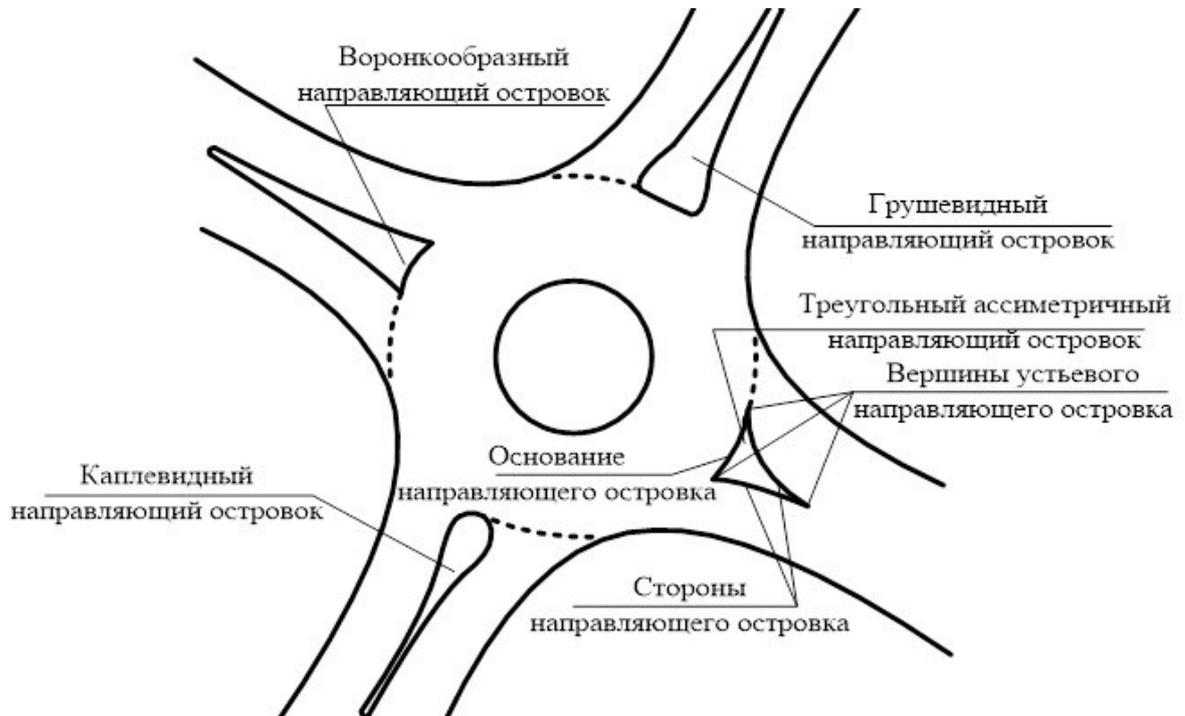
Рисунок 1.7 - Виды, формы и элементы устьевых направляющих островков
