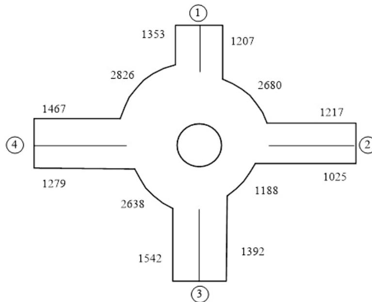
Рисунок 3.6 - Вид эпюры интенсивности движения на кольцевом пересечении
