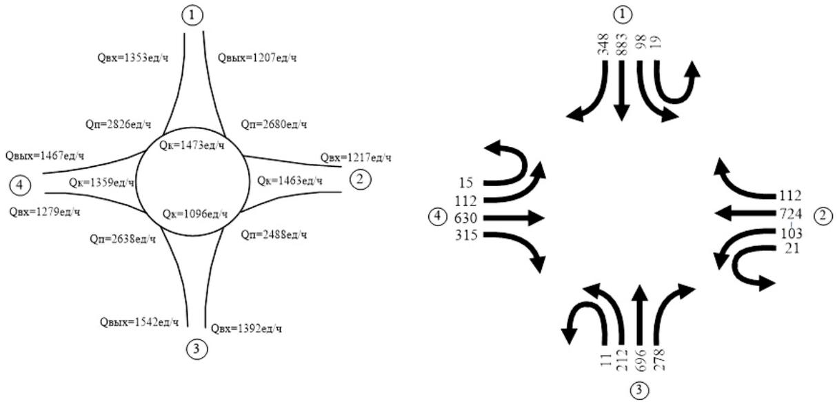
Рисунок 3.8 - Варианты цифрограмм интенсивности движения на кольцевом пересечении
