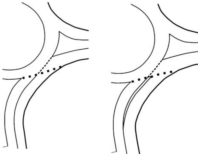
Рисунок 1.13 - Варианты устройства специальных правоповоротных полос
