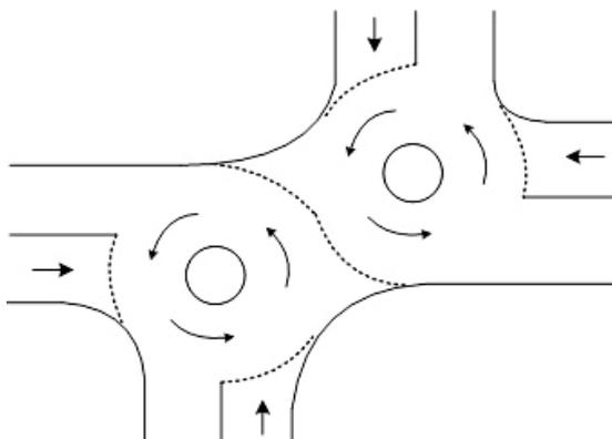
Рисунок 1.23 - Реализация круговой схемы движения на сдвинутом пересечении
