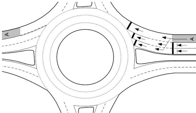
Рисунок 2.13 - Организация приоритетного проезда пересечения методом разнесённых стоп-линий
