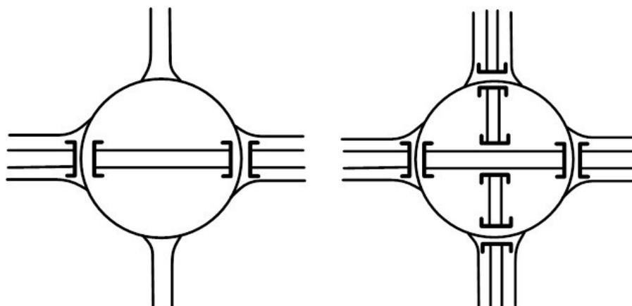
Рисунок 1.26 - Применение кольцевых пересечений в качестве составляющих транспортных развязок
