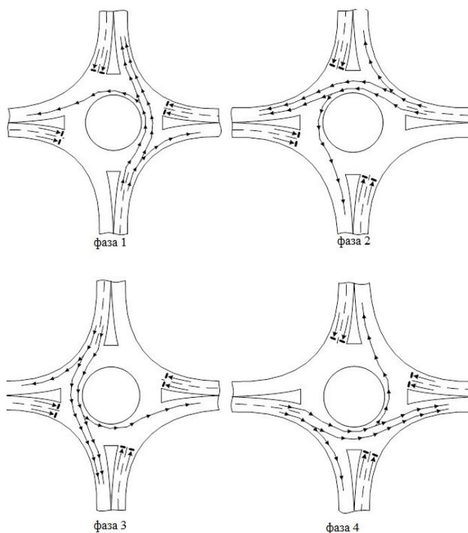
Рисунок 2.17 - Метод организации светофорного регулирования «Зелёная турбина»
