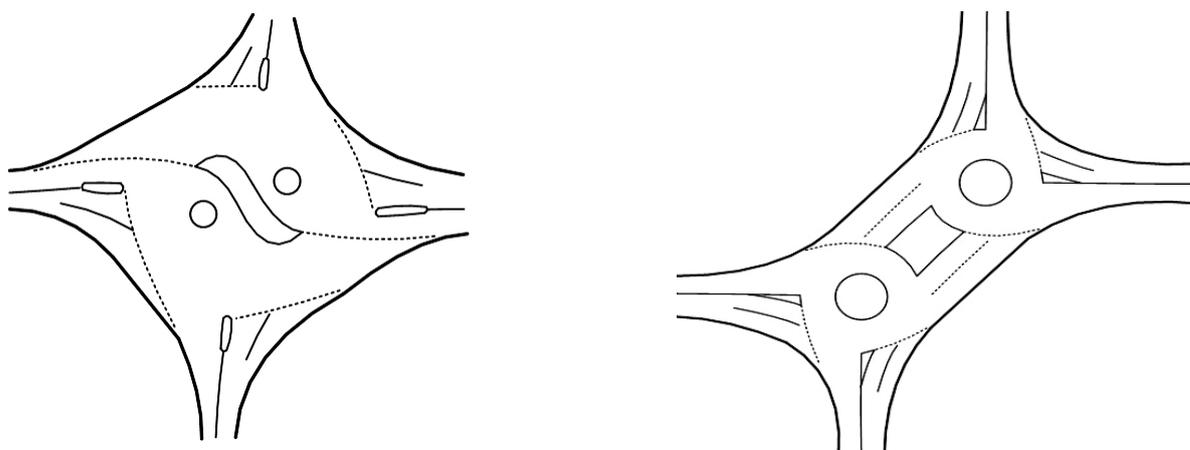
Рисунок 1.29 - Пересечения канализированного типа со сложной планировкой и элементами кругового движения
