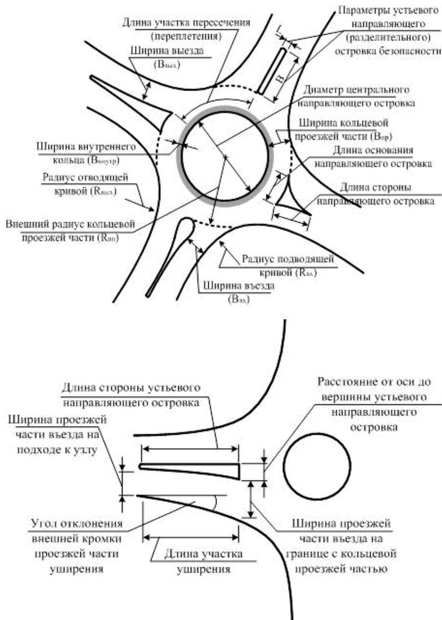
Рисунок 1.2 - Геометрические параметры элементов кольцевых пересечений
