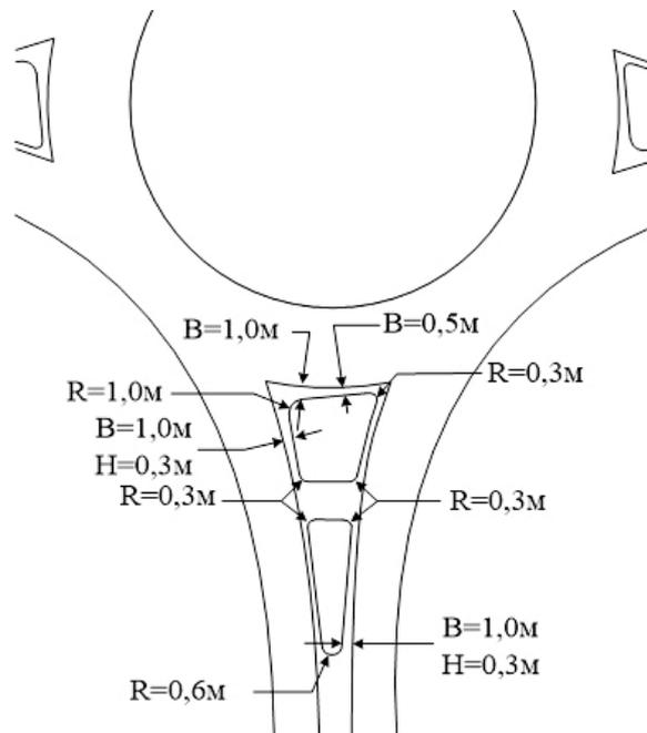
Рисунок 1.8 - Геометрические параметры устьевых направляющих островков
