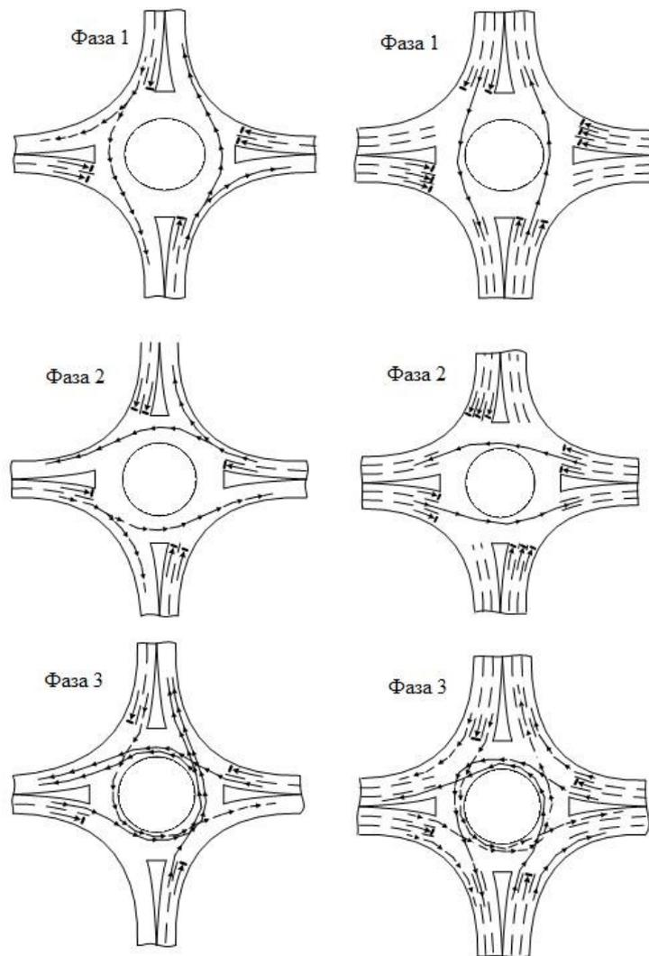
Рисунок 2.18 - Метод организации светофорного регулирования «Классический»
