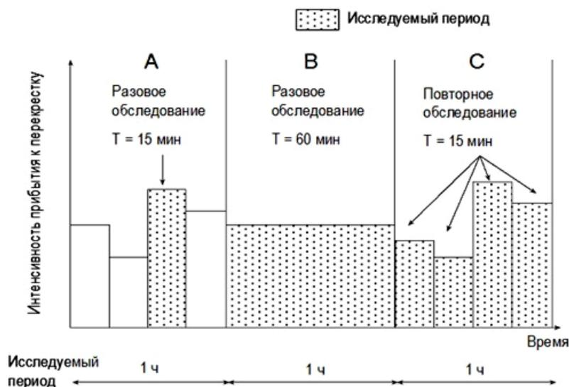
Рисунок 3.3 – Методы измерения пиковой интенсивности движения
