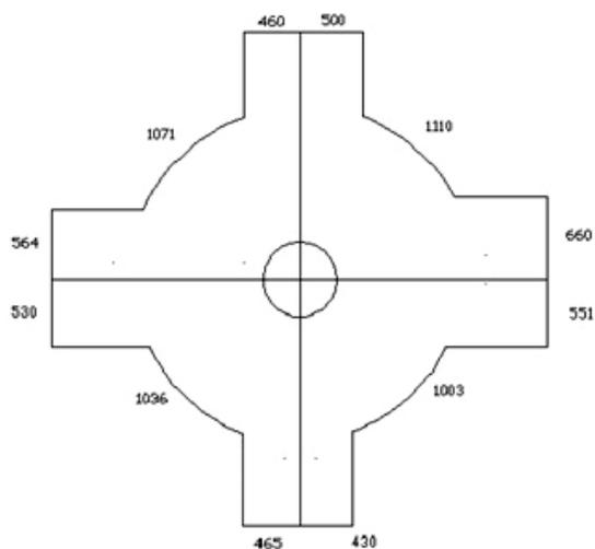
Рисунок 6.1 - Эпюра интенсивности движения в узле
