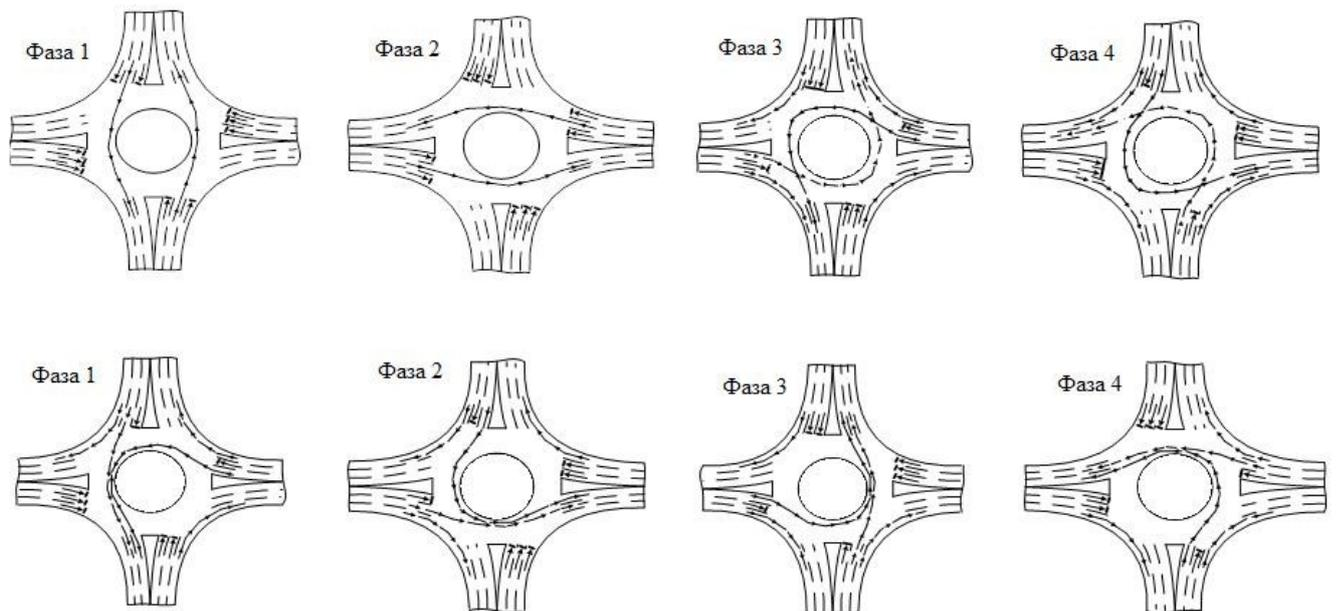
Рисунок 2.19 – Метод организации светофорного регулирования «Смешанный»
