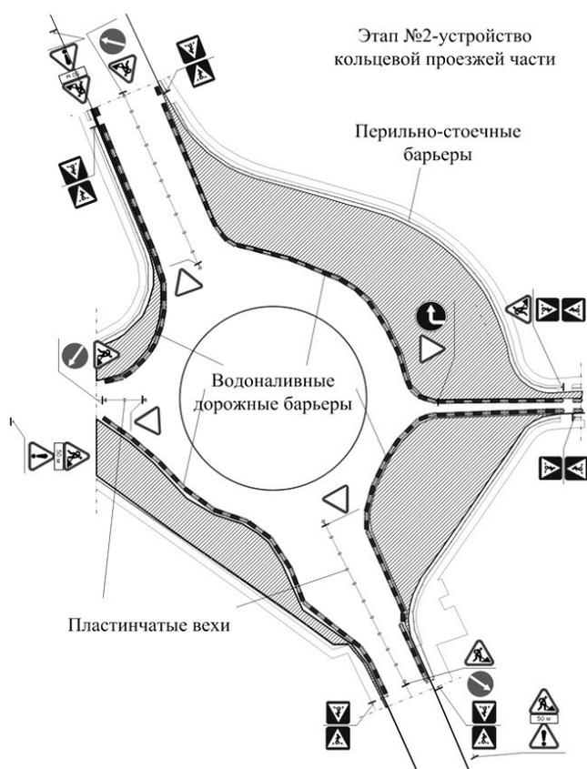
Рисунок 2.23 - Схема организации движения при реконструкции кольцевого пересечения (этап № 2 – устройство кольцевой проезжей части)
