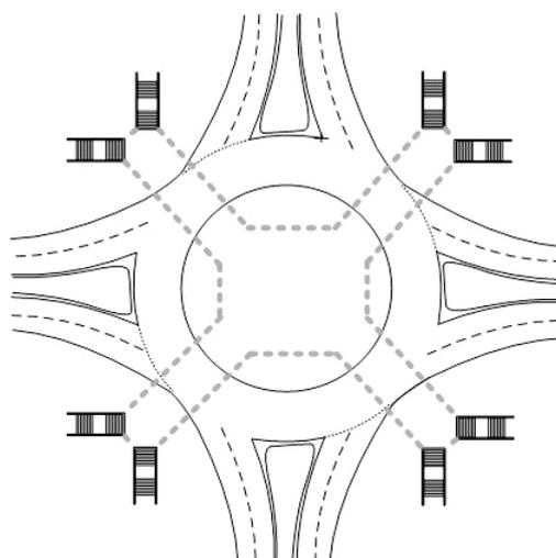
Рисунок 2.4 - Подземный пешеходный переход с устройством общего вестибюля
