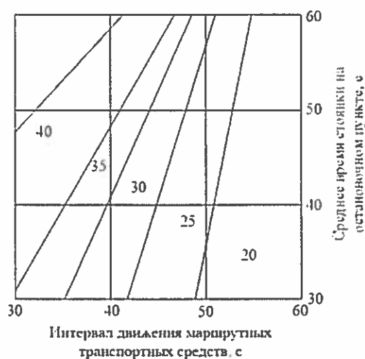
Рисунок 2.8 - Номограмма выбора расстояния удаления остановочного пункта (с двумя местами для маршрутных транспортных средств)
