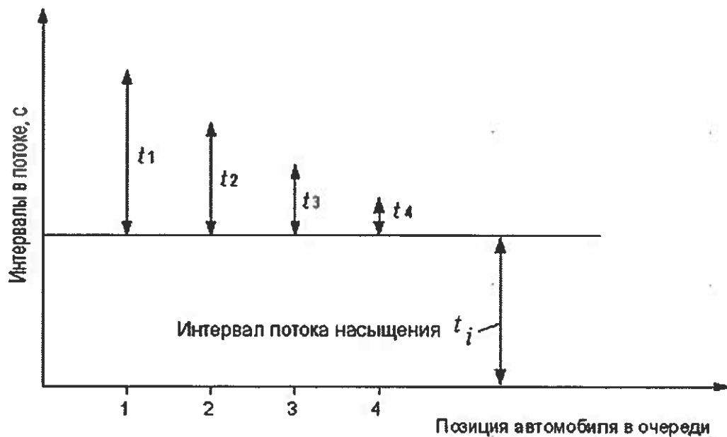
Рисунок 5.1. - Момент наступление потока насыщения: t_i - интервал потока насыщения, наблюдаемый после проезда i - го автомобиля
