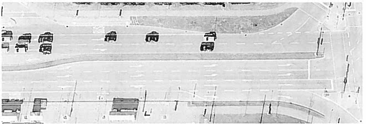
Рисунок 3.14 – Пример устройства сдвоенных выделенных полос для левого поворота – смещение разделительной полосы и отгонка одной из двух левоповоротных полос
