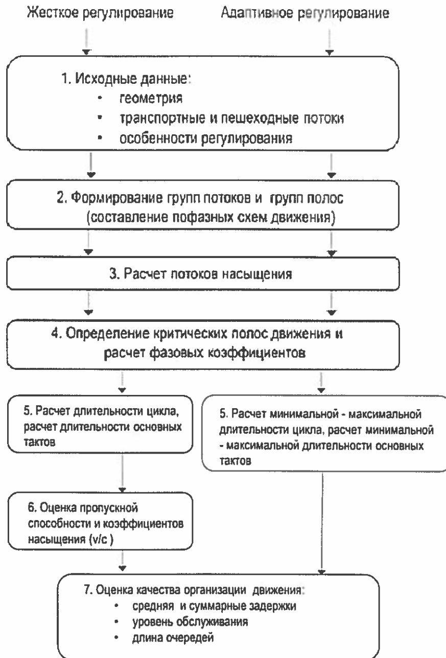
Рисунок 1.5 - Общая последовательность проектирования регулируемого перекрестка.
