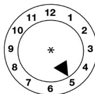
\* На этом месте могут быть указаны две последних цифры года изготовления. В этом случае две последних цифры года в маркировке об утверждении типа и внутри циферблата должны быть одинаковыми.
