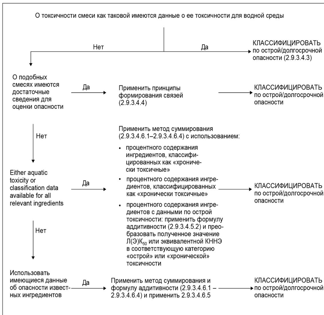
**Рис. 2.9.2.** Многоуровневый подход к классификации смесей по острой и долгосрочной опасности в водной среде
